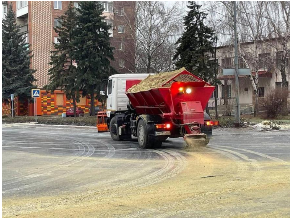
Рисунок 3.2 – Обробка дорожнього покриття піщано-соляними сумішами
