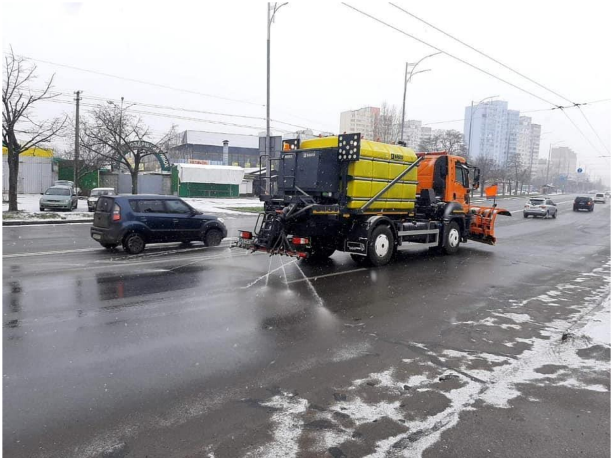
Рисунок 3.3 – Обробка дорожнього покриття хімічним способом
