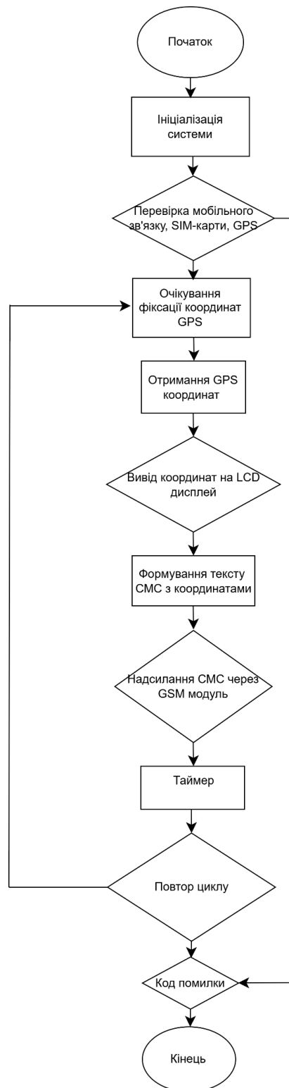
Рисунок 3.1 – Блок-схема логіки роботи пристрою
