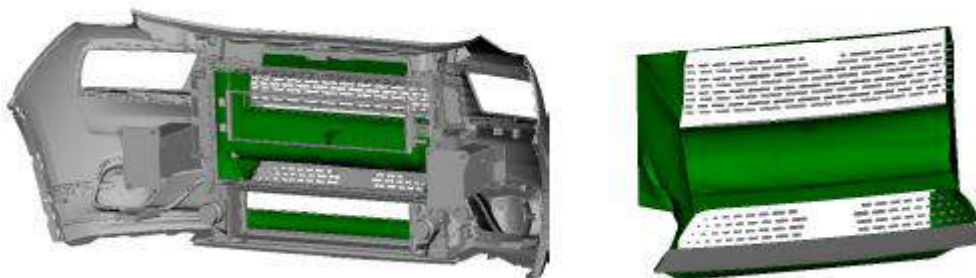
Рисунок 3.10 – Розширюваний поліноміальний канал, з'єднаний між рівнями впуску, конструкція DT3. Вид ззаду між передньою частиною автомобіля та охолоджувальним блоком ліворуч, вид спереду з решітчастою поверхнею ліворуч.
