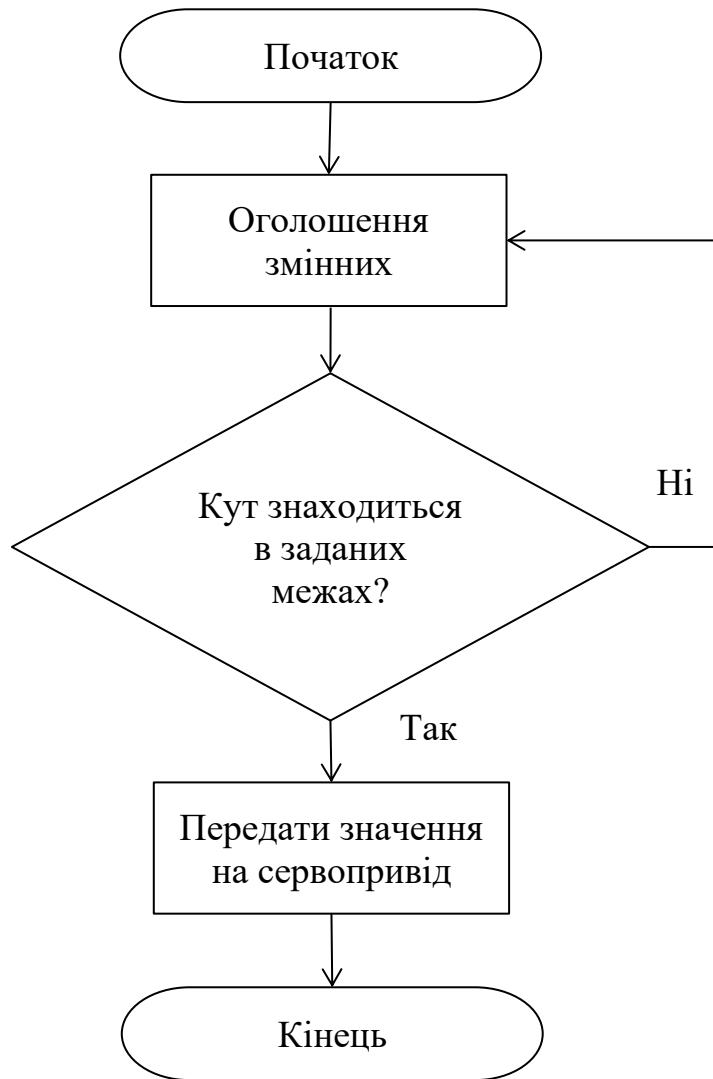
Рисунок 4.2 – Алгоритм керування роботом-маніпулятором через потенціометри
