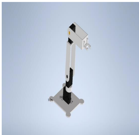
Рисунок 3.1 – Тривимірна модель триланкового міні робота-маніпулятора:
