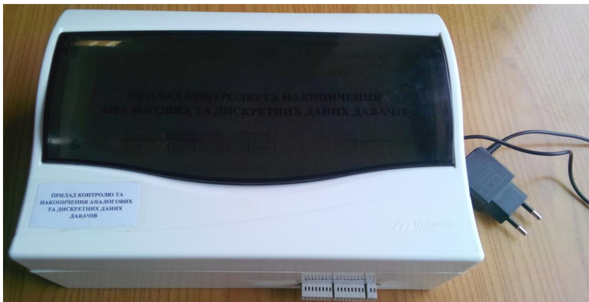
Рисунок 2.6 – Зовнішній вигляд приладу контролю та накопичення аналогових та цифрових параметрів давачів
