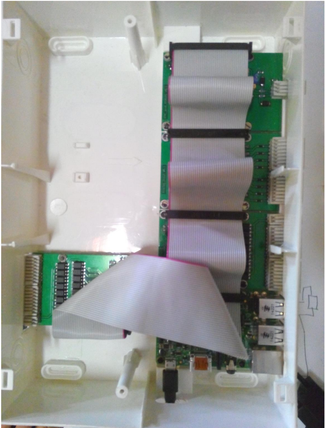
Рисунок 2.7 – Внутрішня будова приладу контролю та накопичення аналогових та цифрових параметрів датчиків
