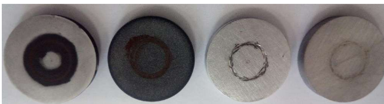
Рисунок 2.7 – Лабораторні зразки після випробувань на коефіцієнт тертя, де зліва направо: з ІУ-покриттям, з МДО-покриттям, без покриття, із сталі 40Х.
