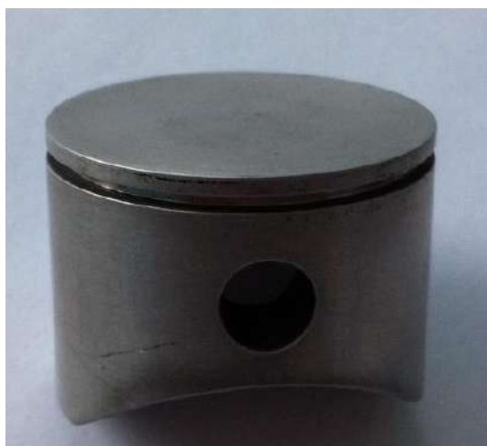
Рисунок 3.11 – Штатний поршень після випробувань
