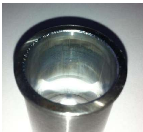
Рисунок 3.10 – Штатна гільза циліндра після випробувань
