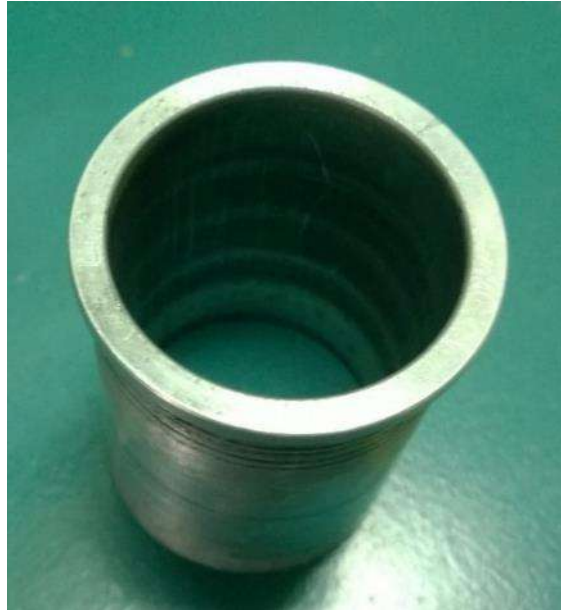
Рисунок 3.13 - Гільза циліндра із сплаву алюмінію АК4-1 після ВП
