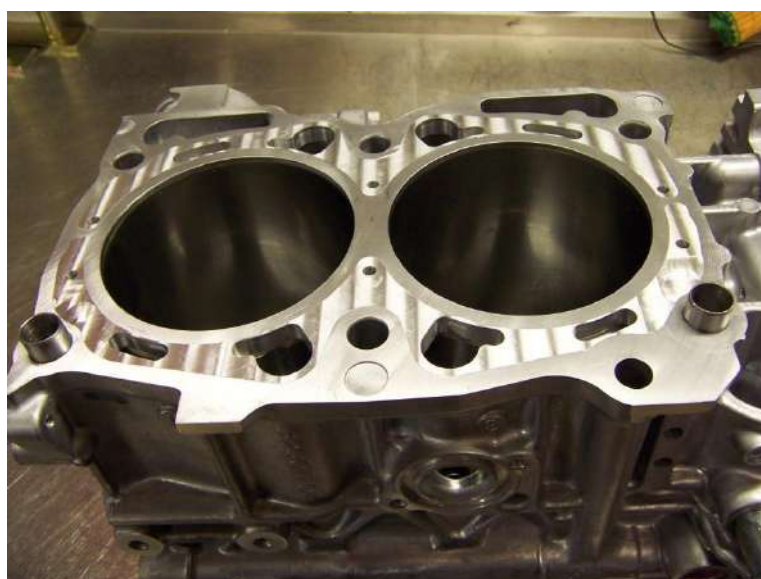
Рисунок 1.3 – Блоки циліндрів конструкції типу «Closed-Deck» [21]
