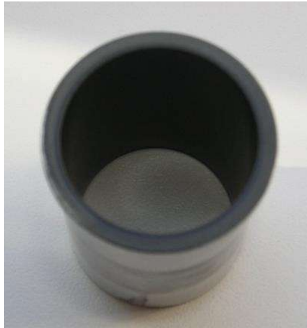
Рисунок 3.12 - Гільза циліндра із сплаву алюмінію АК4-1 після МДО
