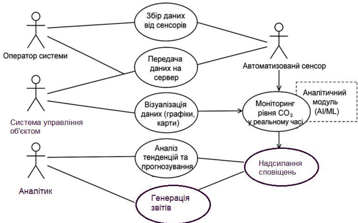
Рисунок 4.4 – Діаграма варіантів використання функціонування кіберфізичної системи відстежування та аналізу викидів CO 2
