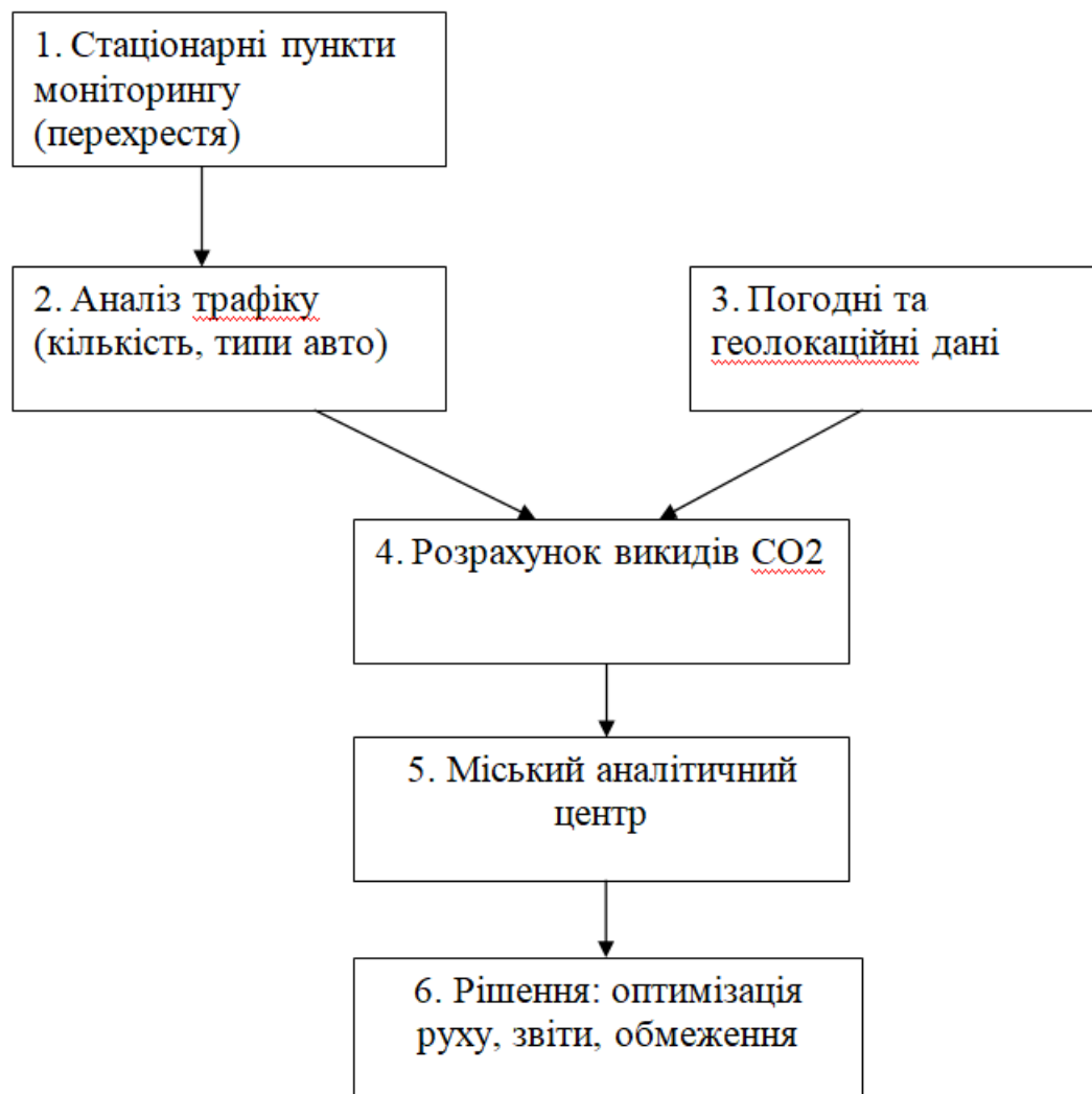
Рисунок 2.3 – Структурна модель процесу відстежування і аналізу викидів вуглецю CO 2 у атмосферу
