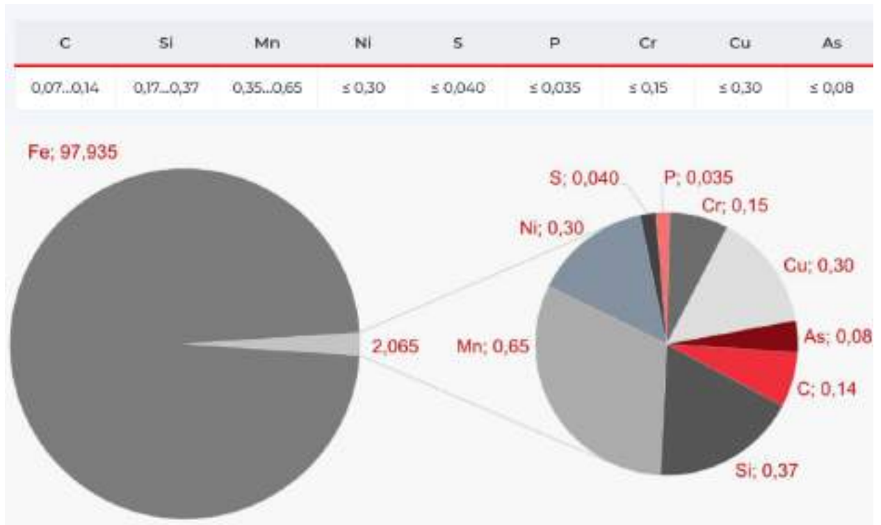
Рисунок 3.17 – Хімічний склад сталі 10
