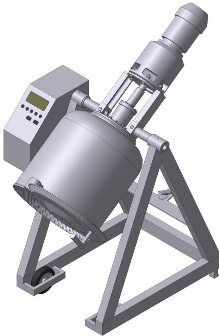
Рис. 3.6. Тістомісильна машина в положенні розвантаження.
