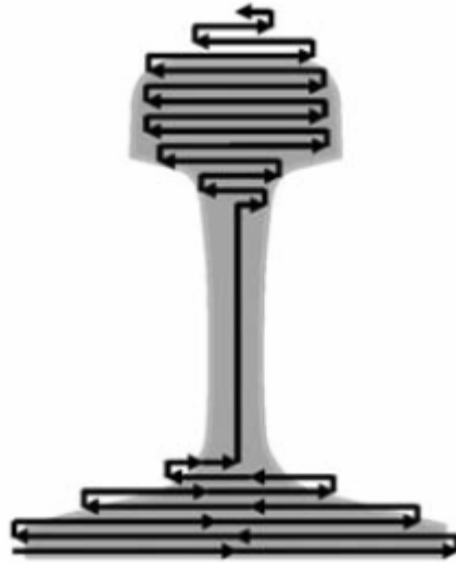
Рисунок 1.7 – Схема руху мундштука
