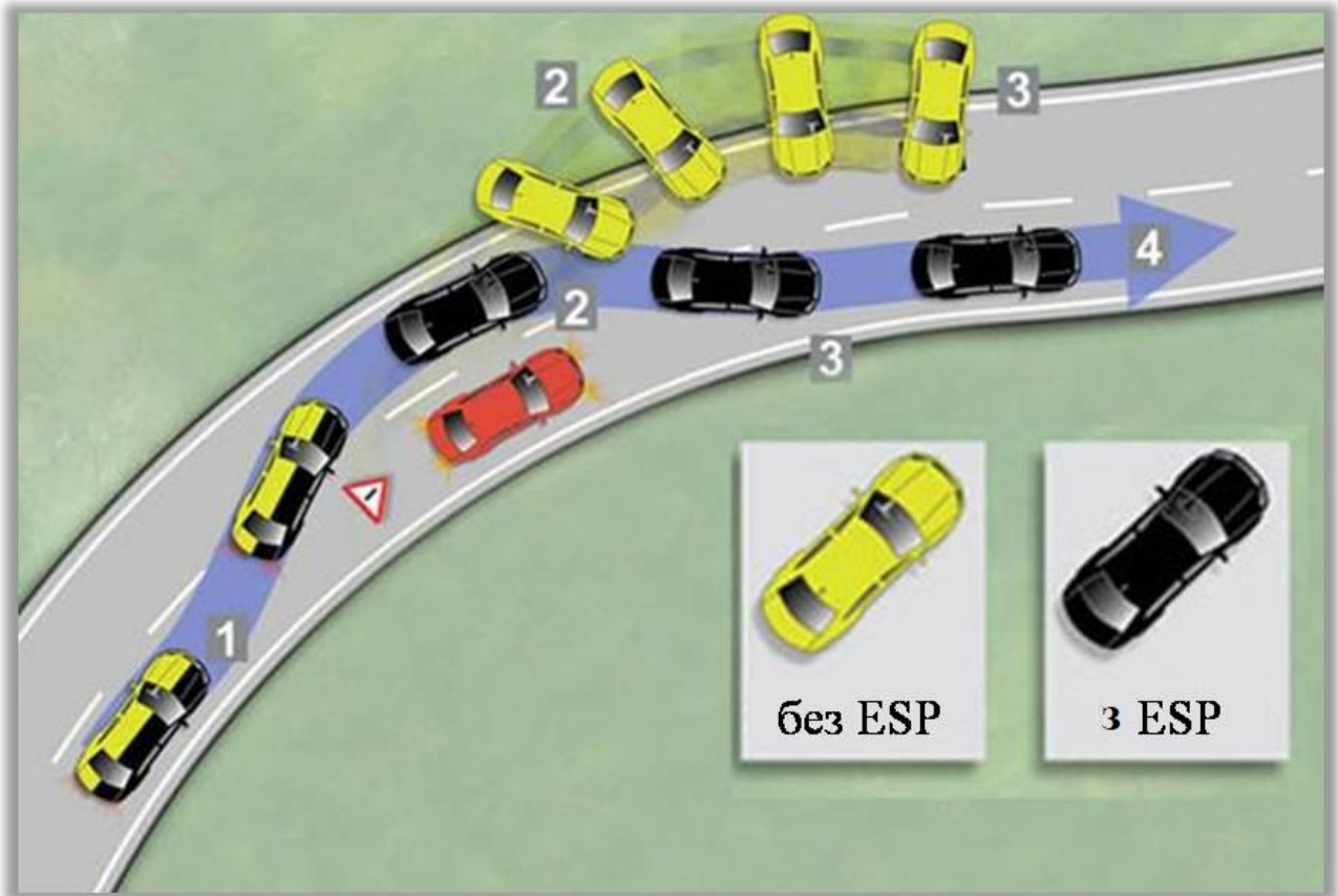
Рисунок 1.8 – Принцип роботи системи стабілізації автомобіля
