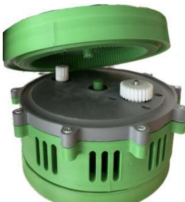
Рисунок 2.6 – Роздрукована на 3D-принтері та зібрана активна частина робота-маніпулятора
