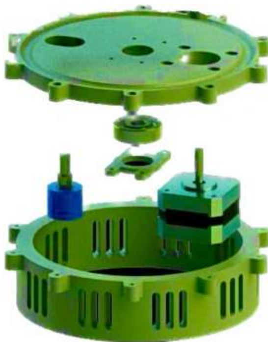
Рисунок 2.4 – Внутрішні складові активної частини робота-маніпулятора
