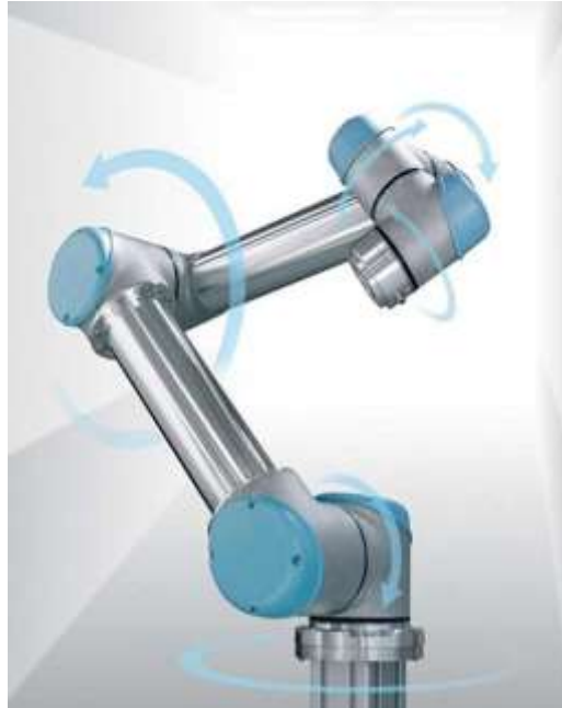
Рисунок 1.2 – Відображення ступенів свободи у робота-маніпулятора серії UR
