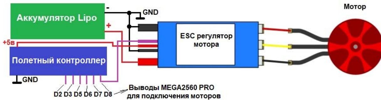
Рис. 5. Подключение шестого мотора к полетному контролеру
