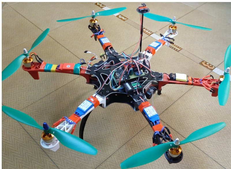
Рис.13. Фото спроектированного гексакоптера на базе Arduino mega2560
