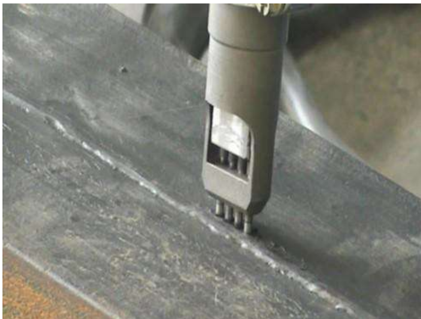
Рисунок 4.2 Зовнішній вигляд пристрою, що зміцнює поверхневий шар механічних деталей за допомогою ультразвукової пластичної деформації
