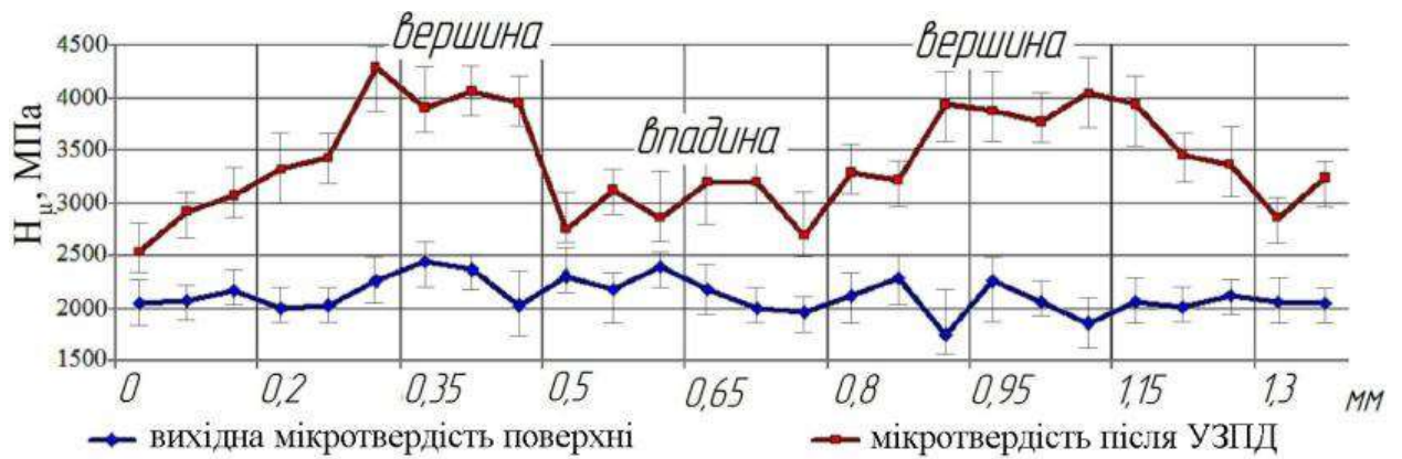
Рисунок 3.9 – Розподіл мікротвердості на поверхні зразка
