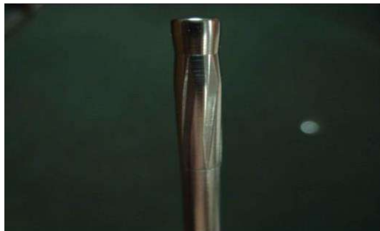
Рисунок 2.3 – Калібрування отвору за допомогою оправки
