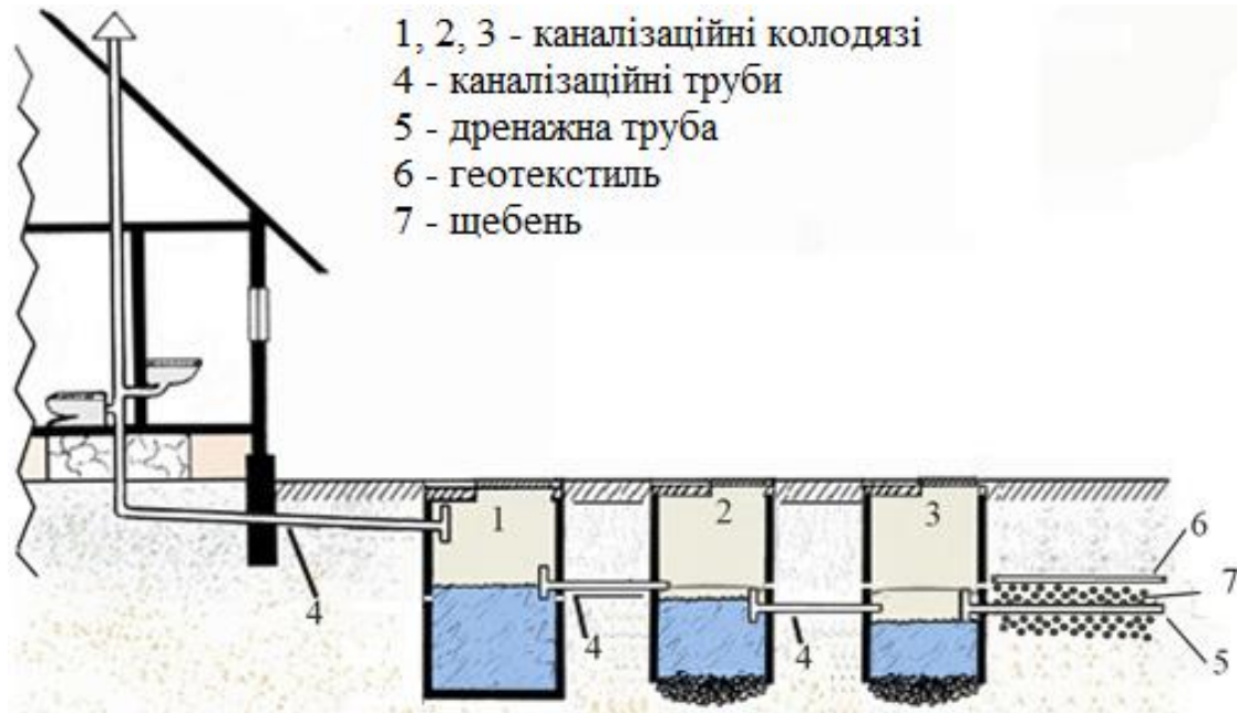
Рисунок 1.5 – Система каналізації приватного будинку
