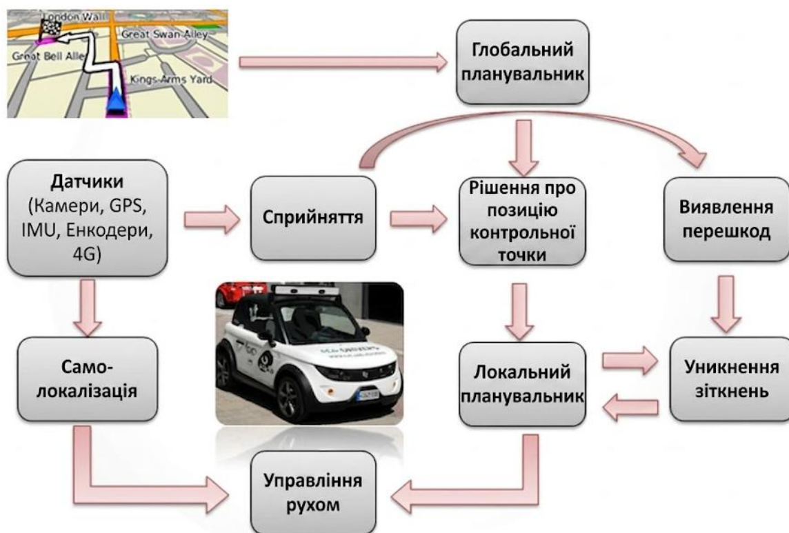
Рисунок 2.1 – Загальна структура архітектури сучасних безпілотних транспортних систем згідно з [6]
