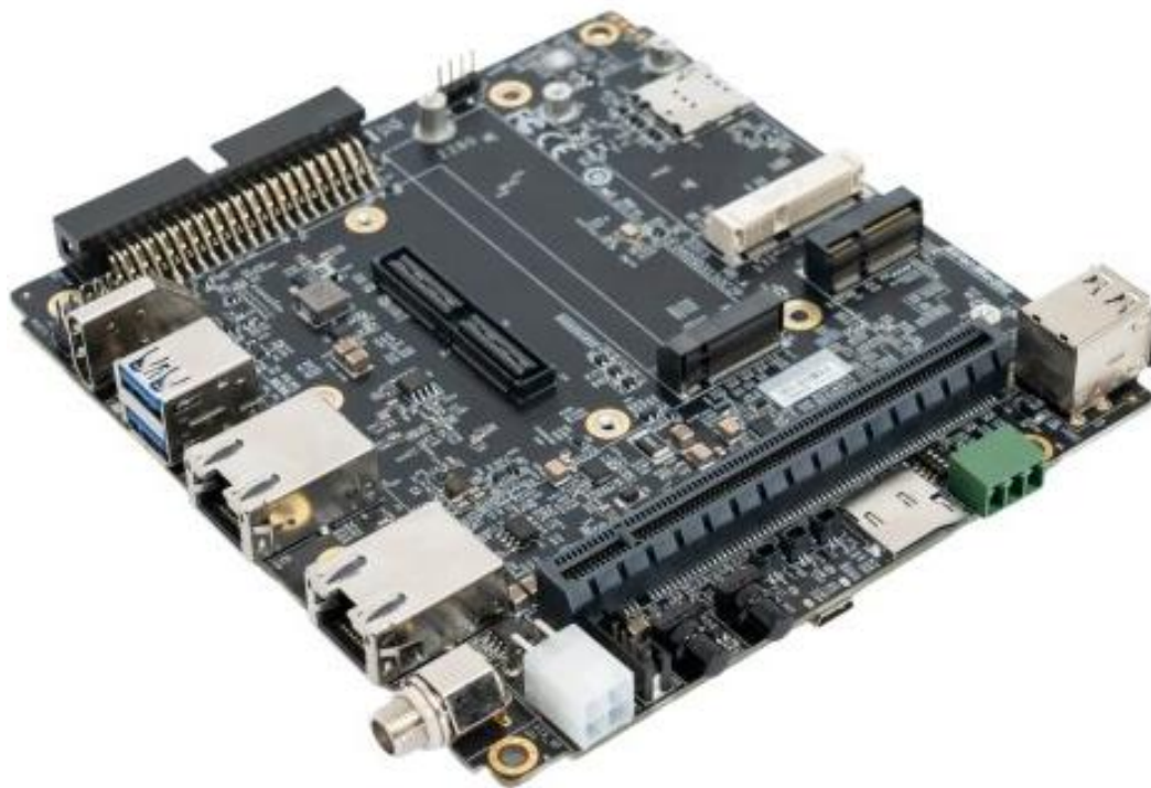
Рисунок 2.6 – Плата-носій AVerMedia D315, створена для модуля NVIDIA® Jetson AGX Orin™ [73]
