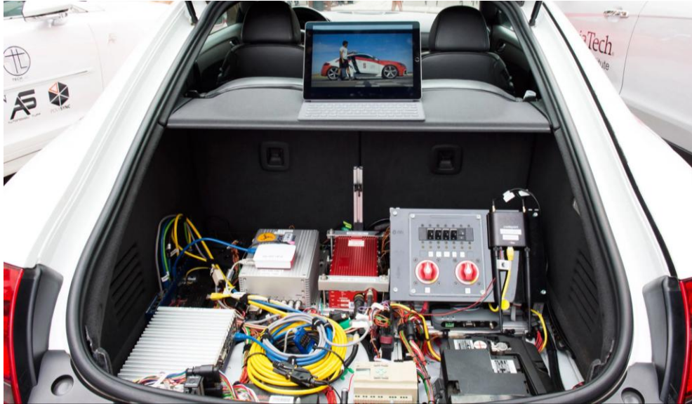
Рисунок 2.4 – Приклад апаратно-програмної архітектури безпілотного автомобіля [71]
