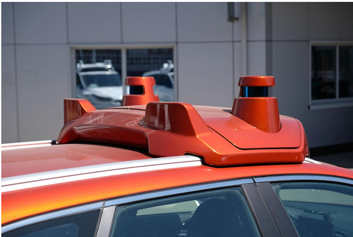
Рисунок 1.6 – Зображення LiDAR на даху безпілотного автомобіля.
