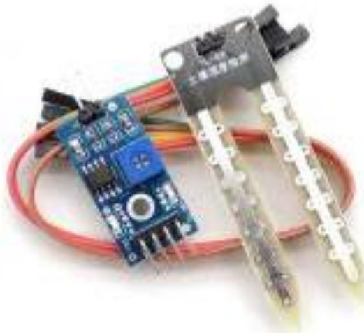
Рисунок 2.7 - Зовнішній вигляд датчику вологості, що розташований в ґрунті
