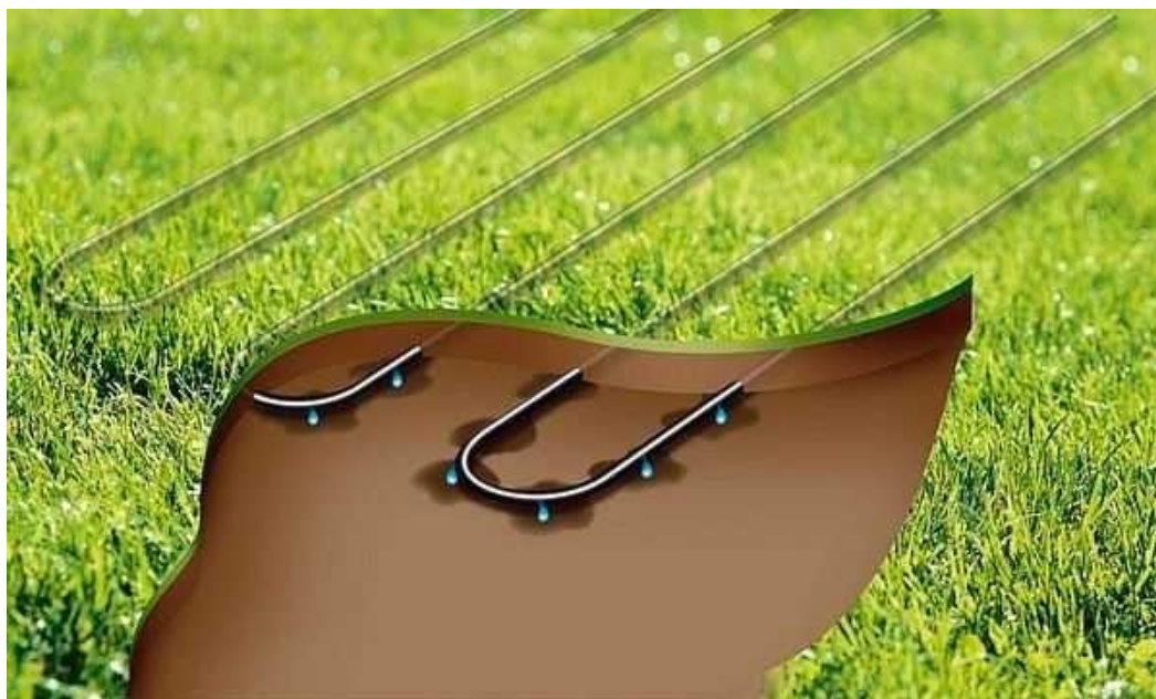
Рисунок 1.8 – Підґрунтове подання води [2]
