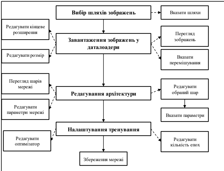
Рисунок 3 – Схема та функції підсистеми взаємодії з НМ
