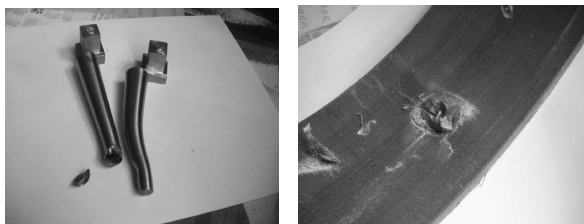
Рис.1 Модели лопаток и корпуса при удержании фрагментов а- модели лопаток, б- корпус
