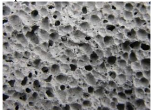
Рис. 1. Порообразная структура ячеистых бетонов
