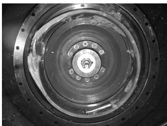
Рис. 2 Общий вид модели корпуса, пробитого лопаткой на разгонном стенде при частоте вращения 21400 об/мин.
