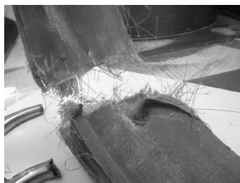
Рис. 3 Разрушенный корпус со стороны удара лопатки.
