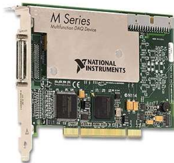
Рисунок 3.11 – Аналого-цифровий перетворювач PCI-6251 Технічна характеристика АЦП PCI-6251 приведена у табл. 3.6.
