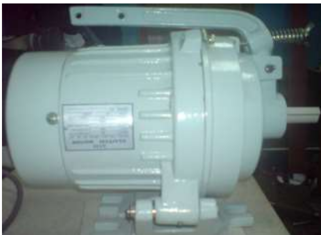
Рисунок 3.2 – Загальний вигляд сучасного фрикційного електричного приводу CLUTCH MOTOR YSL 22-2
