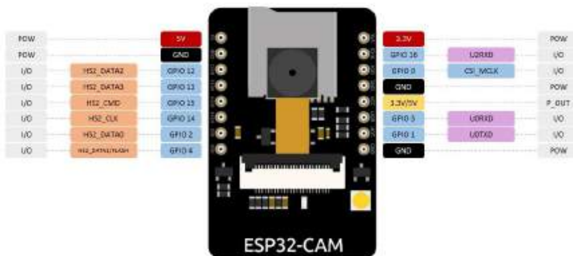
Рисунок 1.6 – Розпинівка ESP32S-CAM модуль HW-818 [24]
