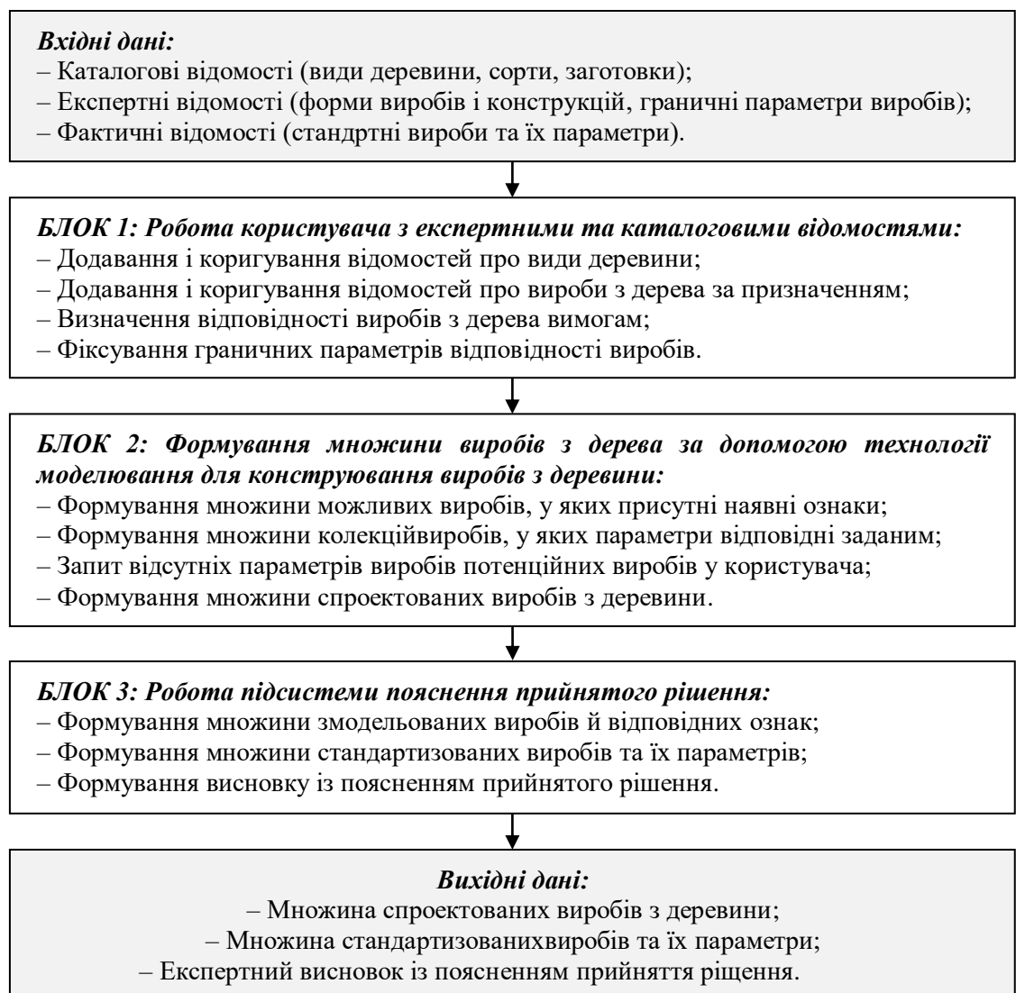
Рисунок 2.3 – Схема інформаційної технології автоматизованого моделювання та конструювання виробів з дерева
