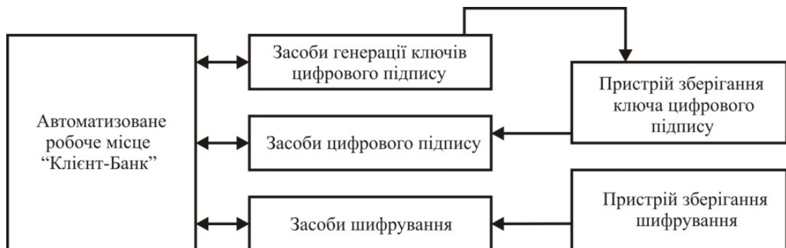
Рис. 3 Схема включення засобів захисту у клієнта
