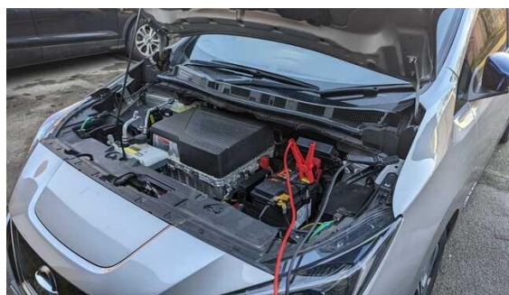
Рисунок 35 – Розміщення допоміжного акумулятора
