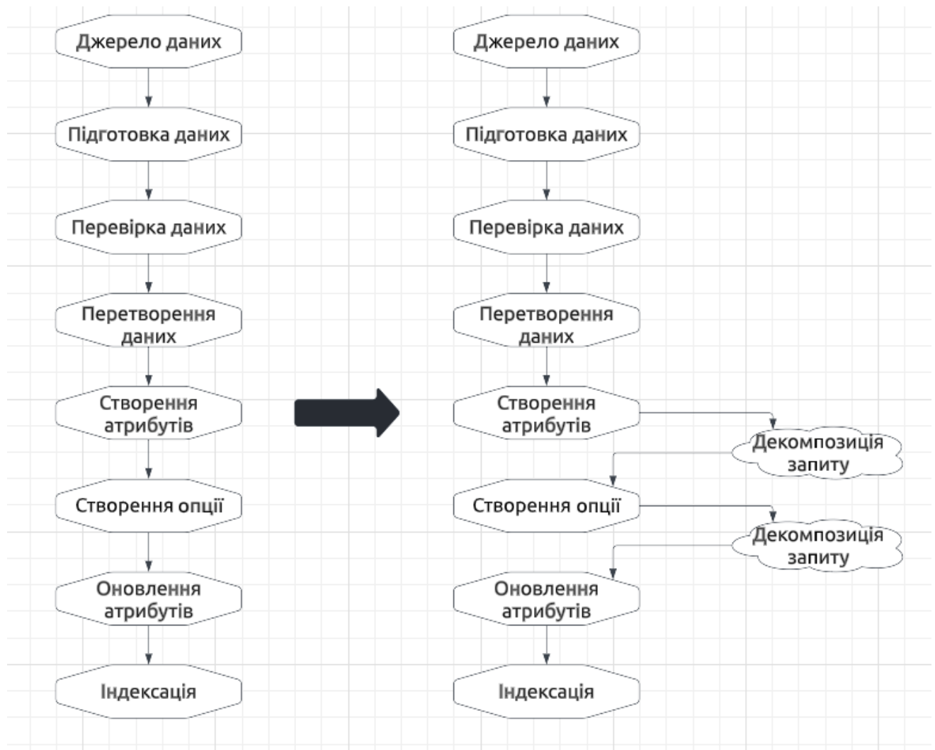
Рисунок 2.7 – Схема що представляє процес трансферу даних для атрибутів з використанням декомпозиції запиту
