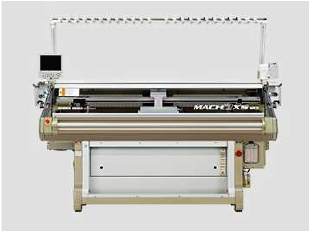
Рисунок 1.2 – В'язальна машина SHIMA SEIKI модель MACH 2XS з 4-ма голечницями й системою підпружинених сінкерів
