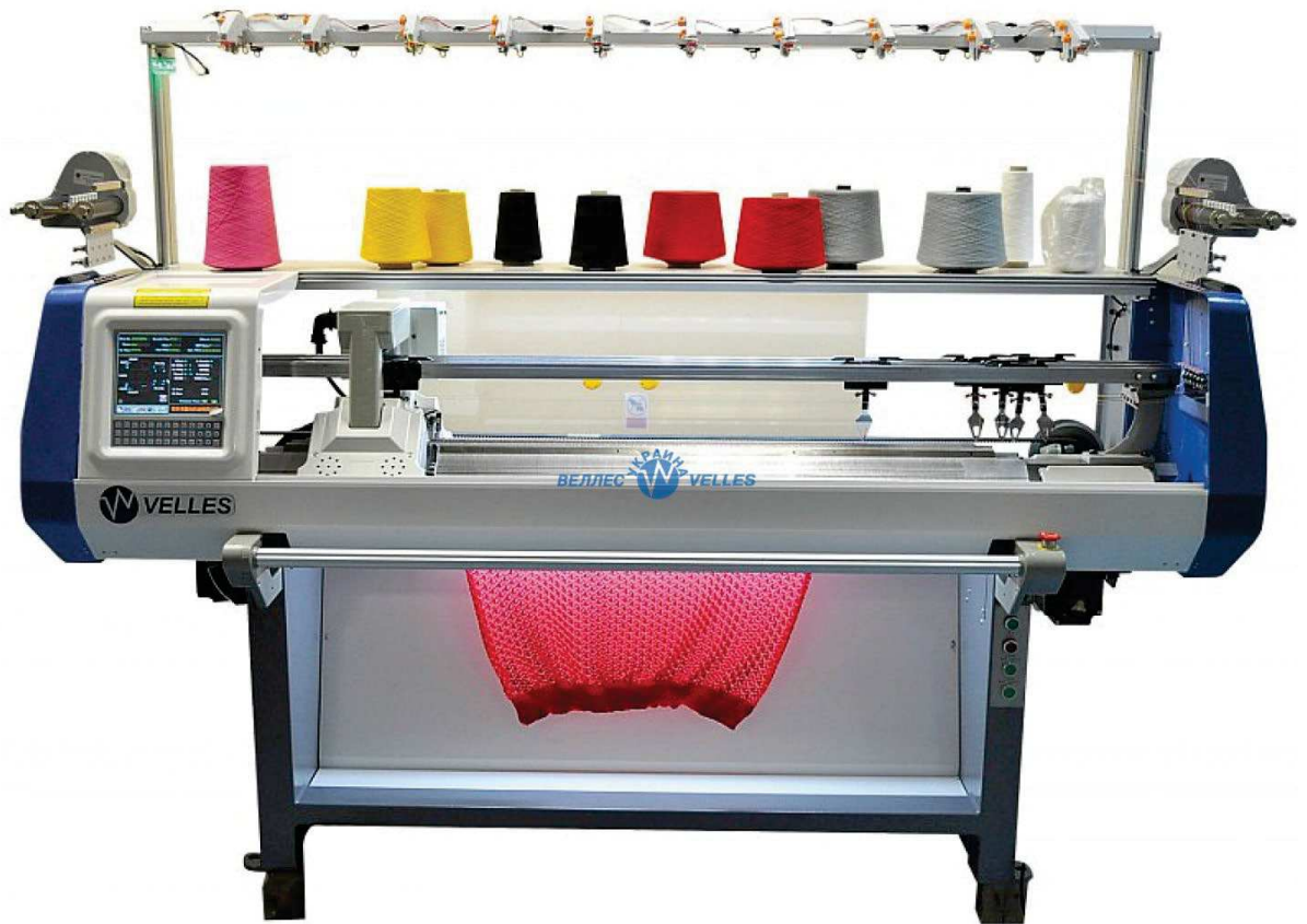
Рисунок 1.3 - Односистемна комп'ютеризована плосков'язальна машина Velles VFK 152NI/P 7G китайського виробництва
