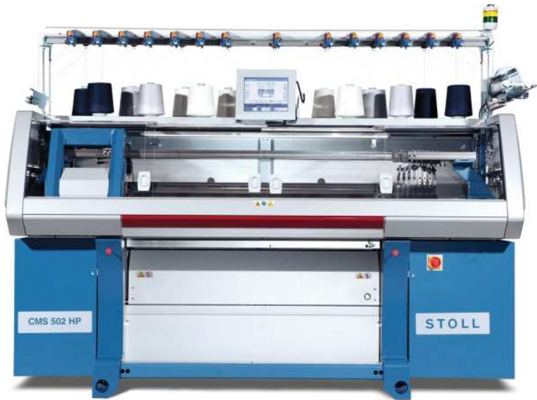
Рисунок 1.1 - Компактна машина Stoll CMS 502 HP з робочою шириною від 45"/114 см, двома системами і підвищеною продуктивністю
