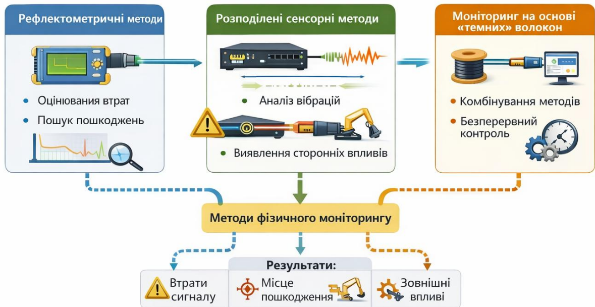
Рисунки 2.1 – Класифікація методів фізичного моніторингу волоконно-оптичних ліній (рефлектометричні, розподілені сенсорні, на основі «темних» волокон).
