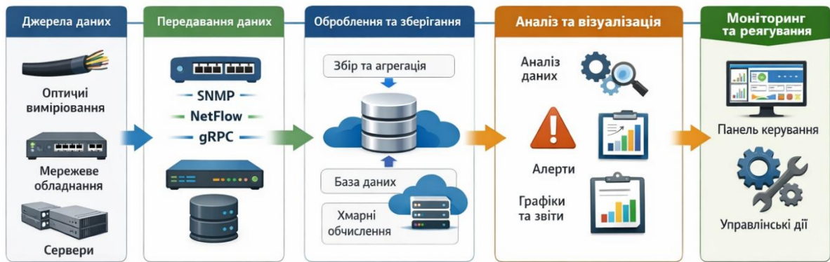
Рисунок 2.2 – Схема телеметричного моніторингу мережевого обладнання (джерела даних, передавання, оброблення, зберігання, візуалізація).
