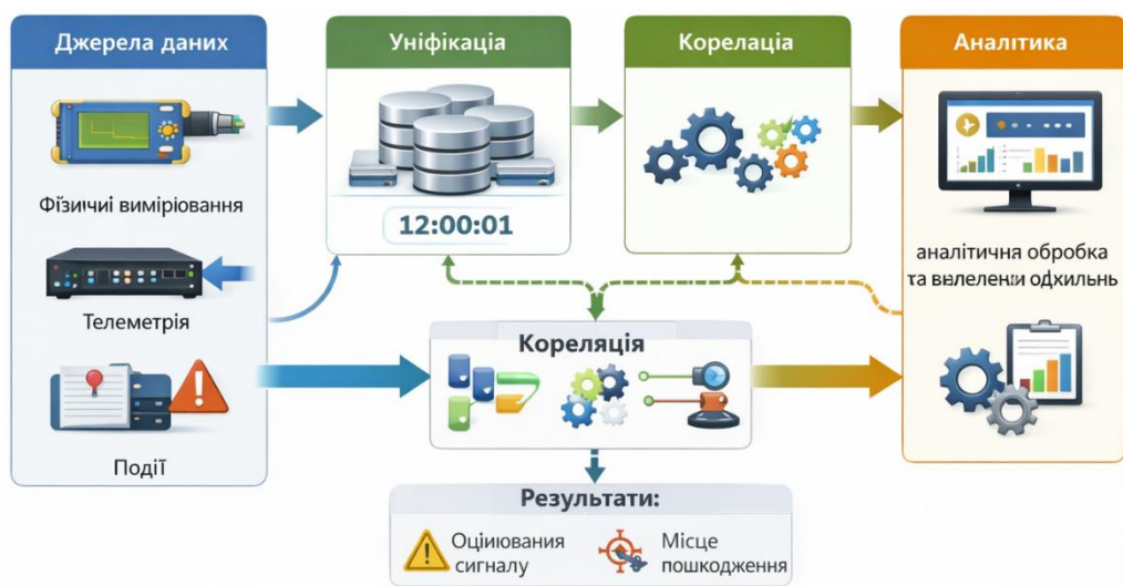
Рисунок 2.3 – Схема інтеграції різномірних даних у кіберфізичній системі (фізичні вимірювання, телеметрія, події → уніфікація → кореляція → аналітика).
