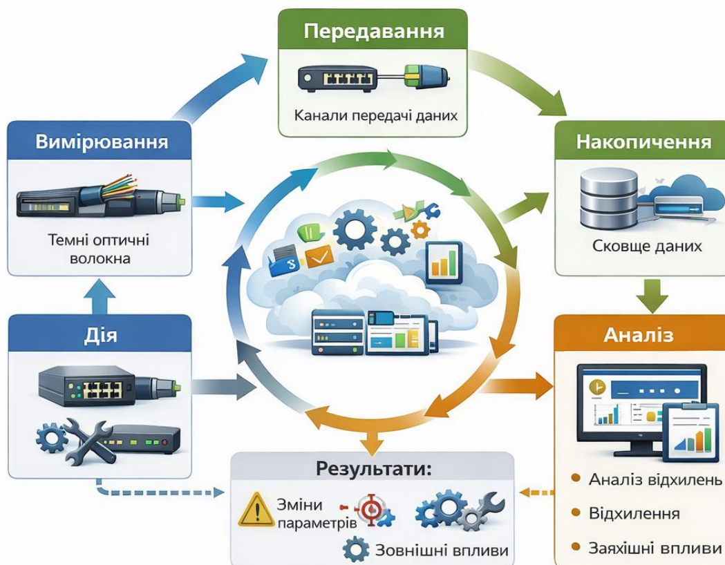
Рисунок 2.5 – Узагальнений цикл функціонування кіберфізичної системи контролю («вимірювання - передавання - накопичення - аналіз - рішення - дія»).
