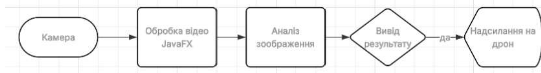
Рисунок 2.8 – блок схема процесу обробки відео
