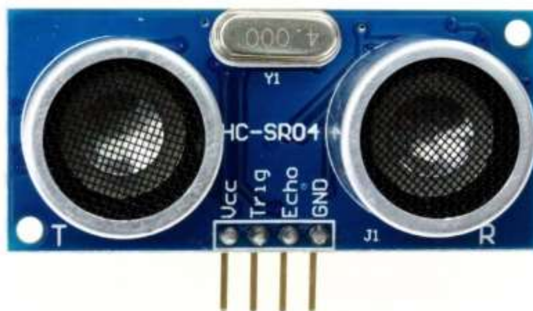
Рисунок 2.5 – Ультразвуковий далекомір HC-SR04 [4]
