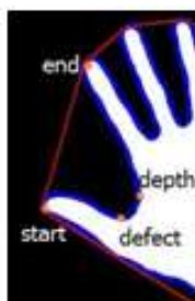
Рисунок 3.5 – Схематичне зображення значень, методу Imgproc.convexityDefects
