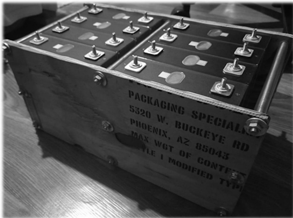
Рисунок 3.11 – Зовнішній вигляд готової конструкції для стиснення комірок
