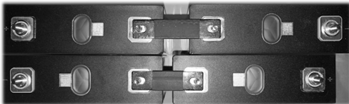
Рисунок 3.10 – Зовнішня різниця між двома перемичками різної довжини
