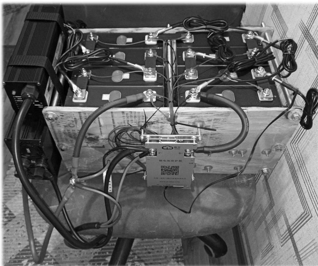
Рисунок 3.14 – Зовнішній вигляд кінцевої збірки, що включає наявність та з'єднання усіх головних компонентів
