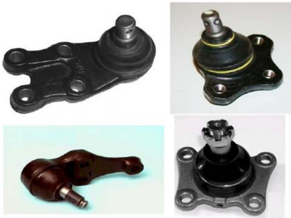
Рис. 2. Типові кульові шарніри автомобіля у різних конструктивних виконаннях
