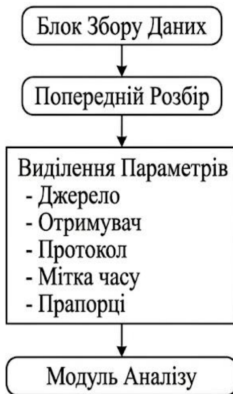
Рисунок 3.4 – Структура обробки мережевого пакета
