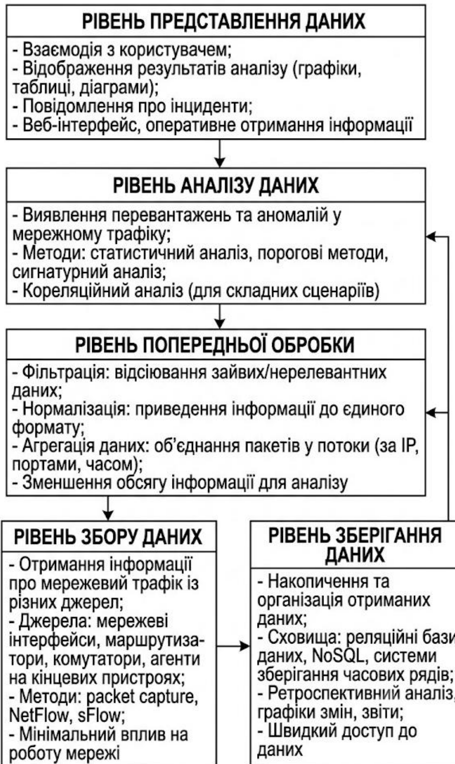
Рисунок 2.1 – Архітектура системи моніторингу мережного трафіку
