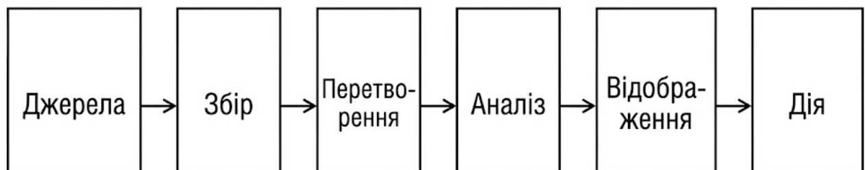
Рисунок 1.2 – Архітектура системи моніторингу
