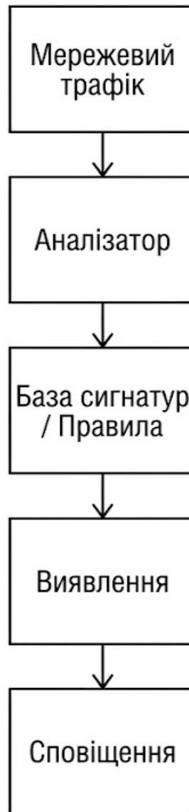
Рисунок 1.3 – Принцип роботи системи IDS
