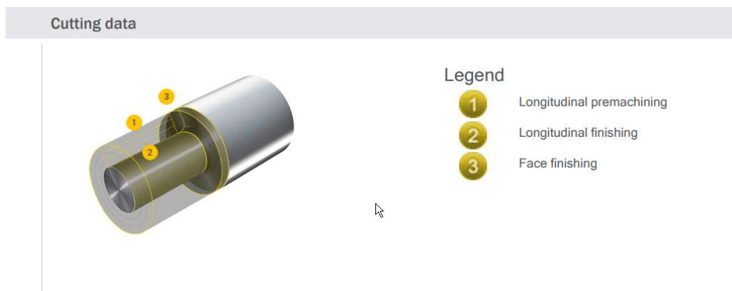
Рисунок 2.18 Спрощена циклограма обробки обраної поверхні
