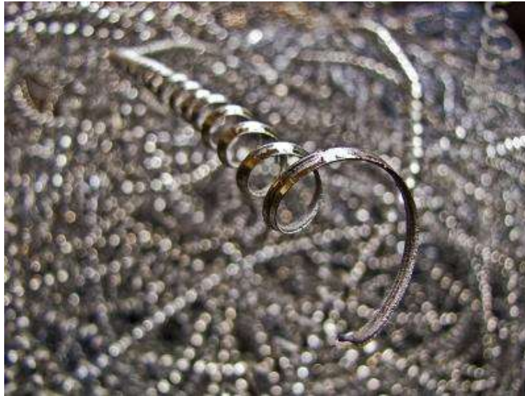
Рисунок 4.2 Стружка при роботі за токарним верстатом
