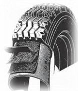
Рисунок Б.44 – Будова радіальної шини
