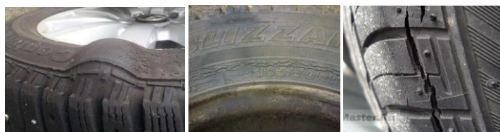
Рисунок Б.82 – Види несправностей шини
