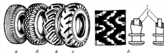
а – дорожній; б – універсальний; в – протектори підвищеної прохідності; г – кар'єрний; д – зимовий. 1 – осердя; 2 – корпус шипа Рисунок Б.53 – Малюнки протектора шин
