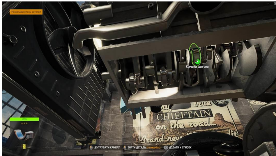
Рисунок 41 – Демонтаж кришки шатуна
