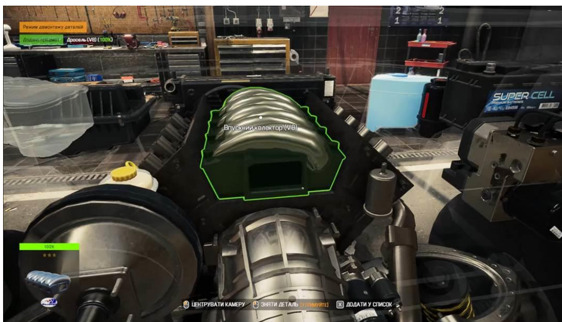
Рисунок 36 – Демонтаж впускного колектора
