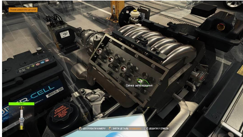
Рисунок 33 – Демонтаж свічок запалювання
