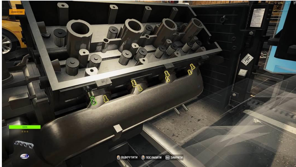
Рисунку 37 – Демонтаж випускного колектора
