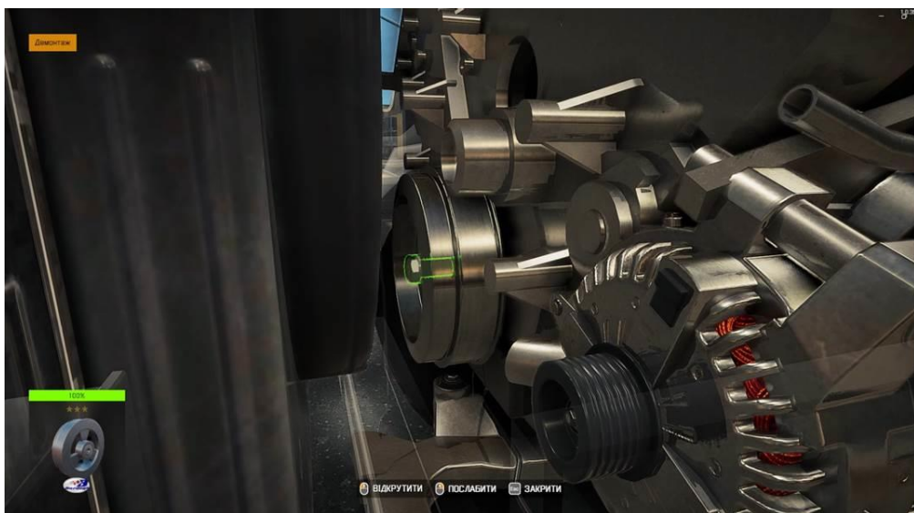
Рисунок 28 – Демонтаж шківів колінчастого валу.
