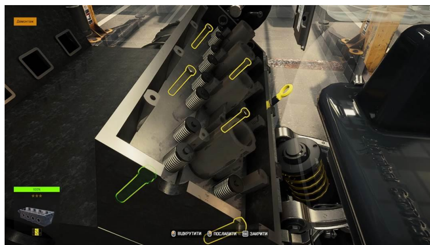
Рисунок 38 – Демонтаж головки блоку циліндрів
