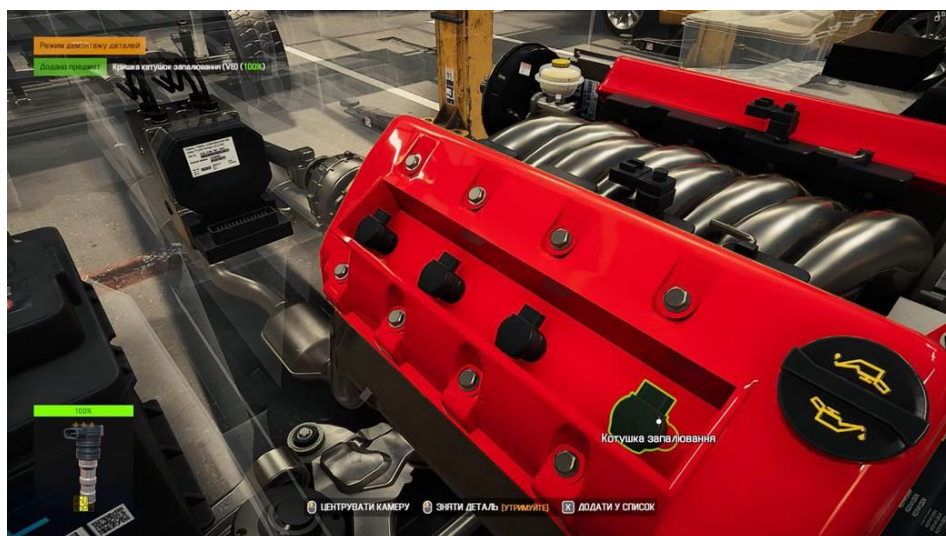
Рисунок 22 – Демонтаж катушок запалювання
