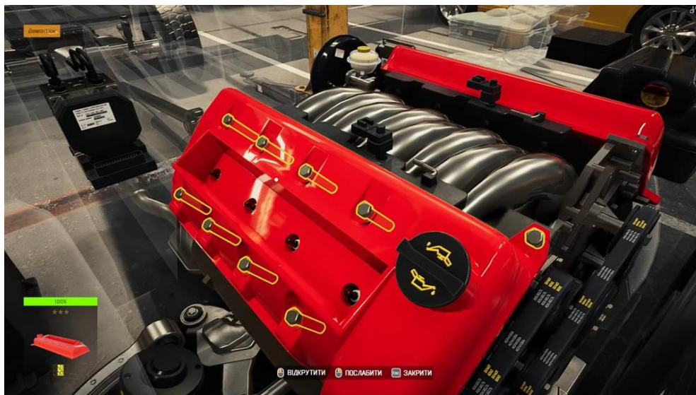
Рисунок 23 – Демонтаж кришки головки блоку циліндрів (V8)
