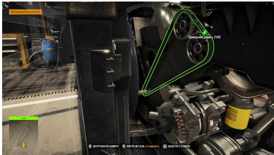
Рисунок 31 – Демонтаж шестерні розподільного валу
