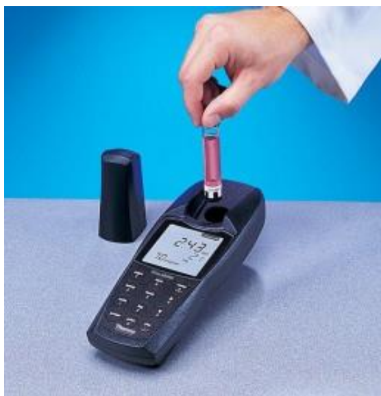
Рисунок 4 - Фотоколориметр Thermo Orion AQUAfast IV моделі AQ4000.
