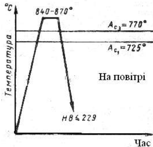
Рисунок 4.3 – Графік режимів нормалізації напавленої вал-шестерні
