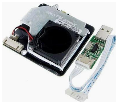
Рисунок 2.4 – Лазерний сенсор SDS011
