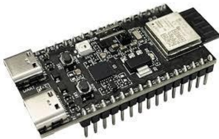
Рисунок 2.1 – Зовнішній вигляд мікроконтролера ESP32
