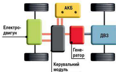
Рисунок 1.9 – Послідовна схема гібридної силової установки.
