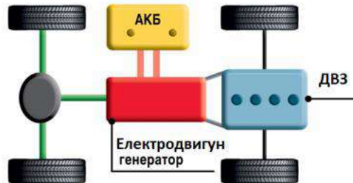
Рисунок 1.10 – Паралельна схема гібридної силової установки
