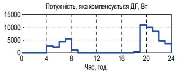
Рисунок 2.8 - Результати розрахунку добової роботи гібридної автономної електростанції
