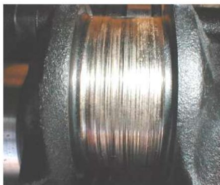
Рисунок 3.5 – Задири шийки вала
