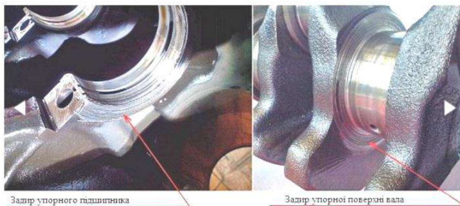
Рисунок 3.4 – Задири упорних поверхонь
