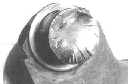
Рисунок 3.7 – Злам шийки колінчастого валу
