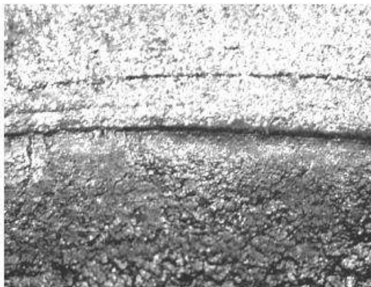
Рисунок 3.8 – Макроструктура зламу у щоці: перехід із зони розвитку тріщини у зону руйнування (50:1)
