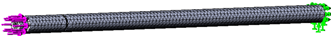
Рис. 1 – Скінченно-елементна сітка моделі гвинта
