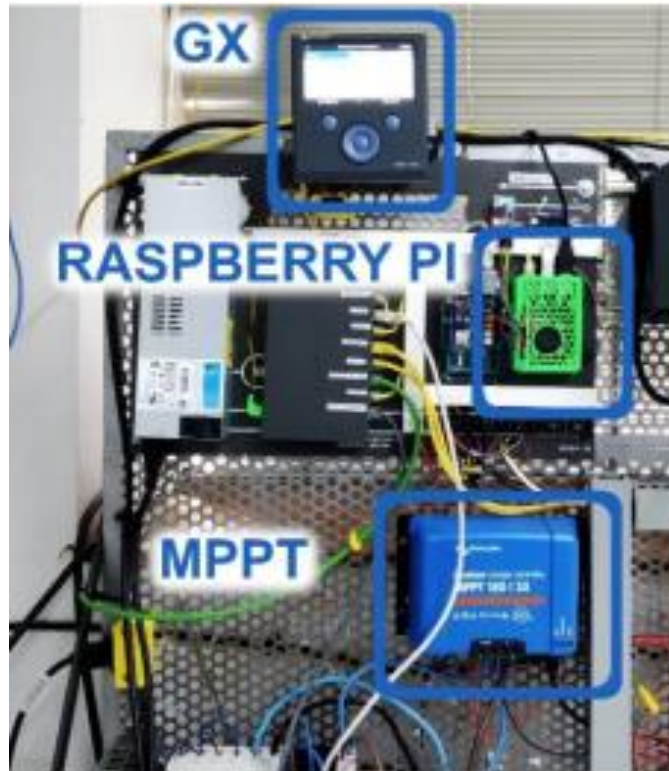
Рисунок 2.15 – Raspberry Pi, шлюз GX та зарядний пристрій MPPT
