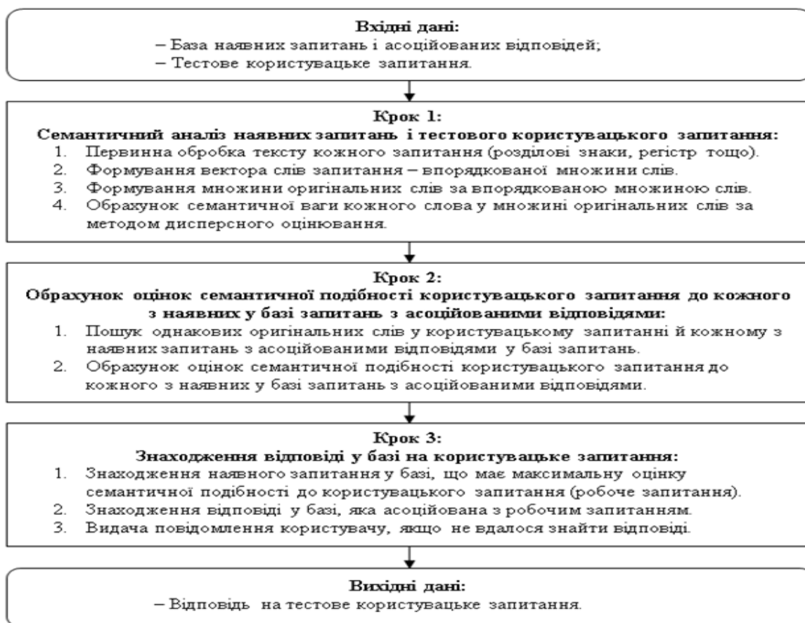
Рис. 1. Схема методу автоматизованого підбору відповідей на користувацькі запитання за семантичною подібністю
