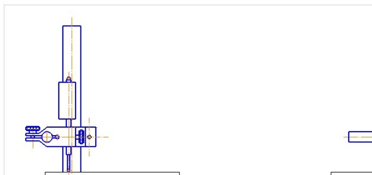
Рис. 3.7 – Схема вимірювання відхилення від паралельності.
