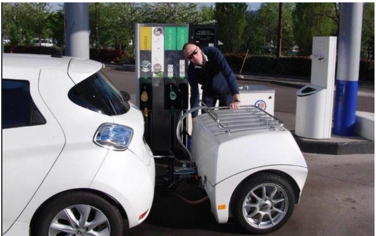
Рисунок 1.6 – Зарядка електромобіля від бензогенератора
