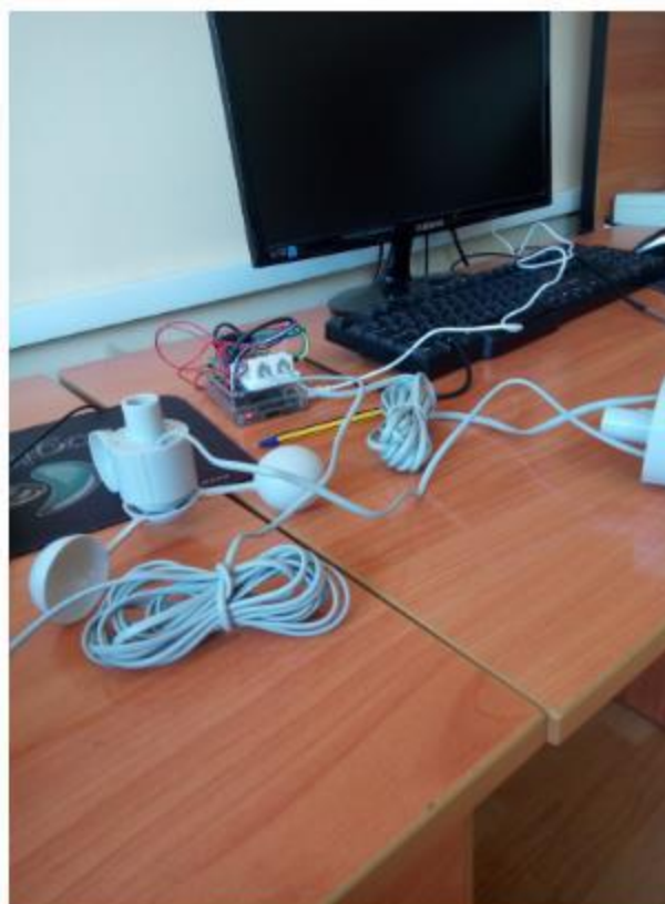
Рисунок 3.2 – Повністю зібрана метеостанція
