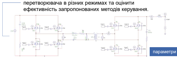
Рис. 10 - Імітаційна модель резонансного перетворювача LLC
