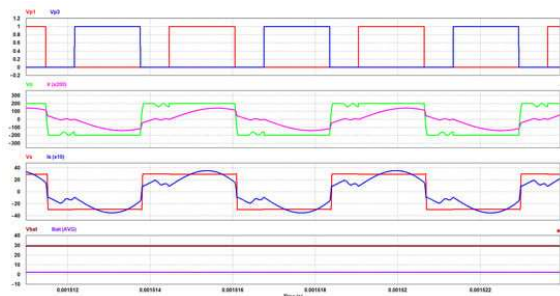
Рис.12 – Резонансний перетворювач LLC ШІМ моделювання
