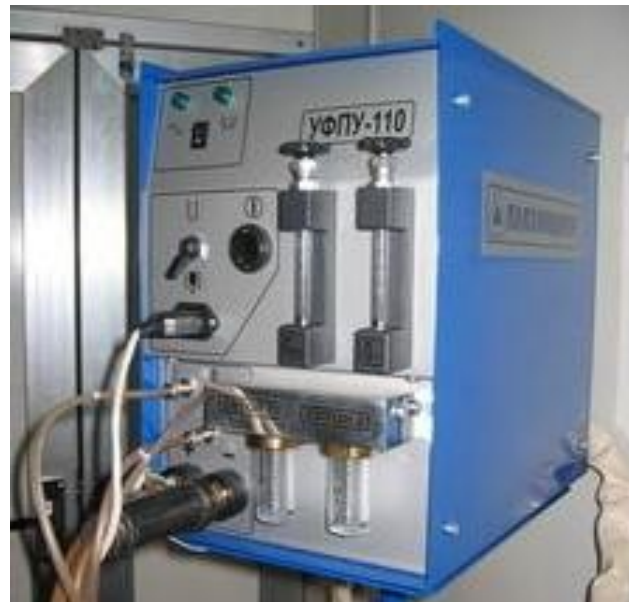
Рисунок 6 - Блок обладнання з живильником рідини
