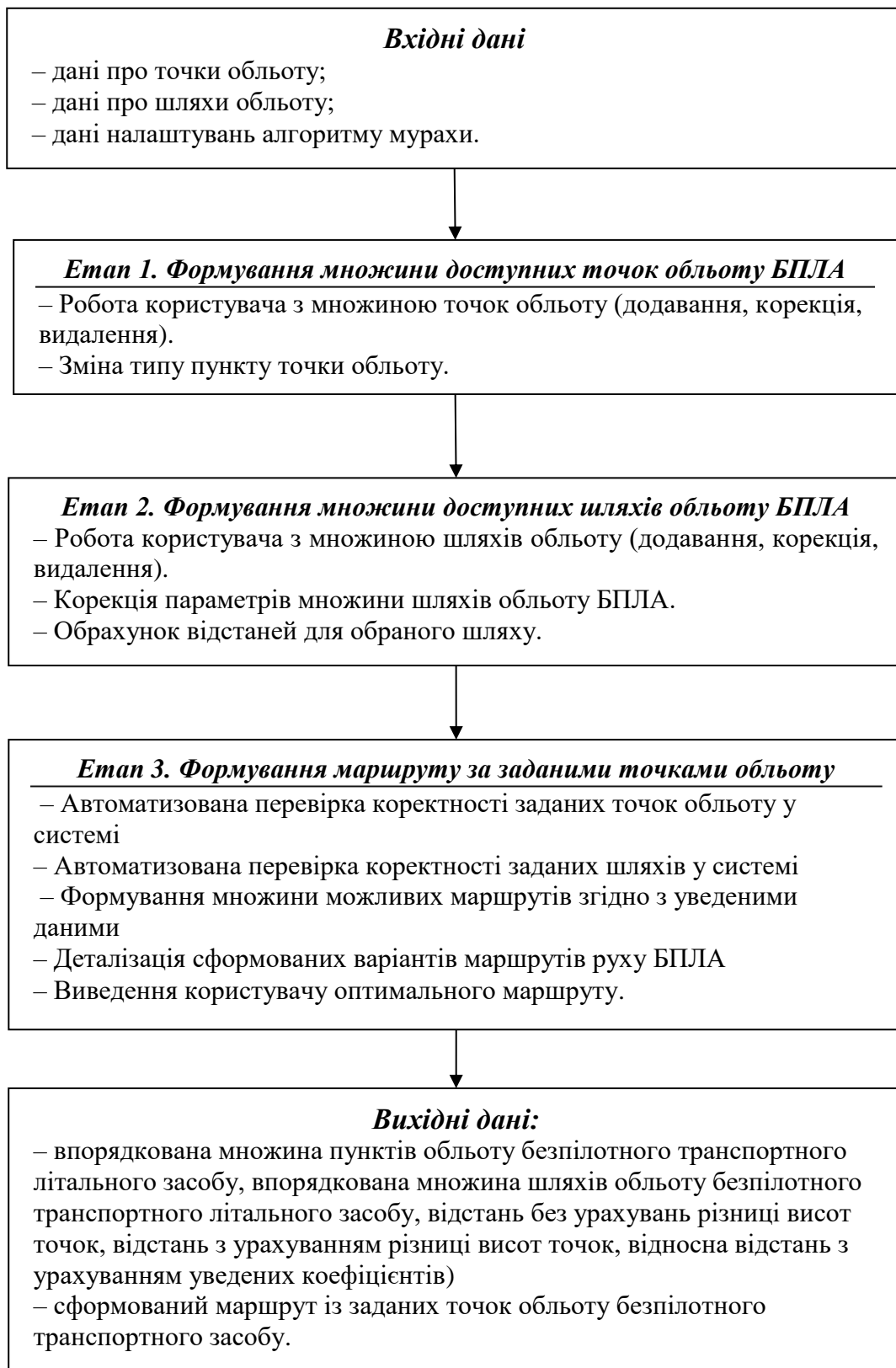
Рисунок 3.1 – Етапи роботи інформаційної системи автоматизованого планування маршрутів пересування повітряних безпілотних транспортних засобів
