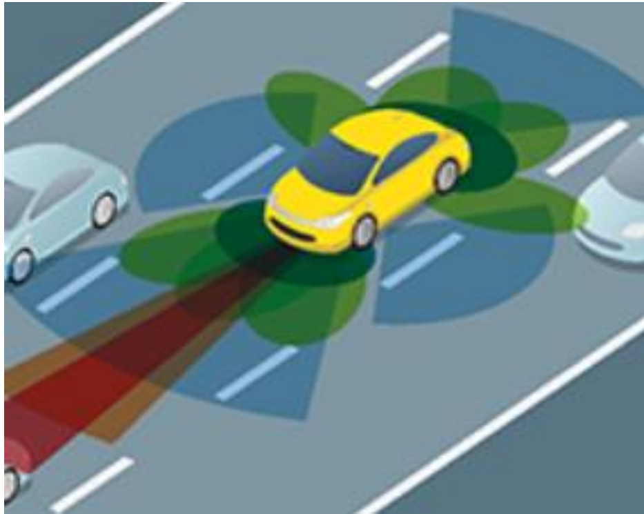
Рисунок 1.8 – Розташування зон видимості різних датчиків безпілотного автомобіля [17]
