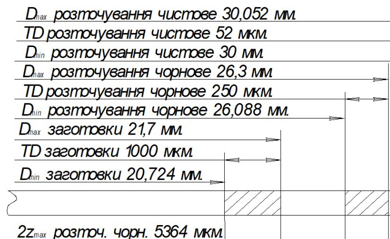
Рисунок 2.1 – Ілюстраційна схема розташування припусків та допусків
